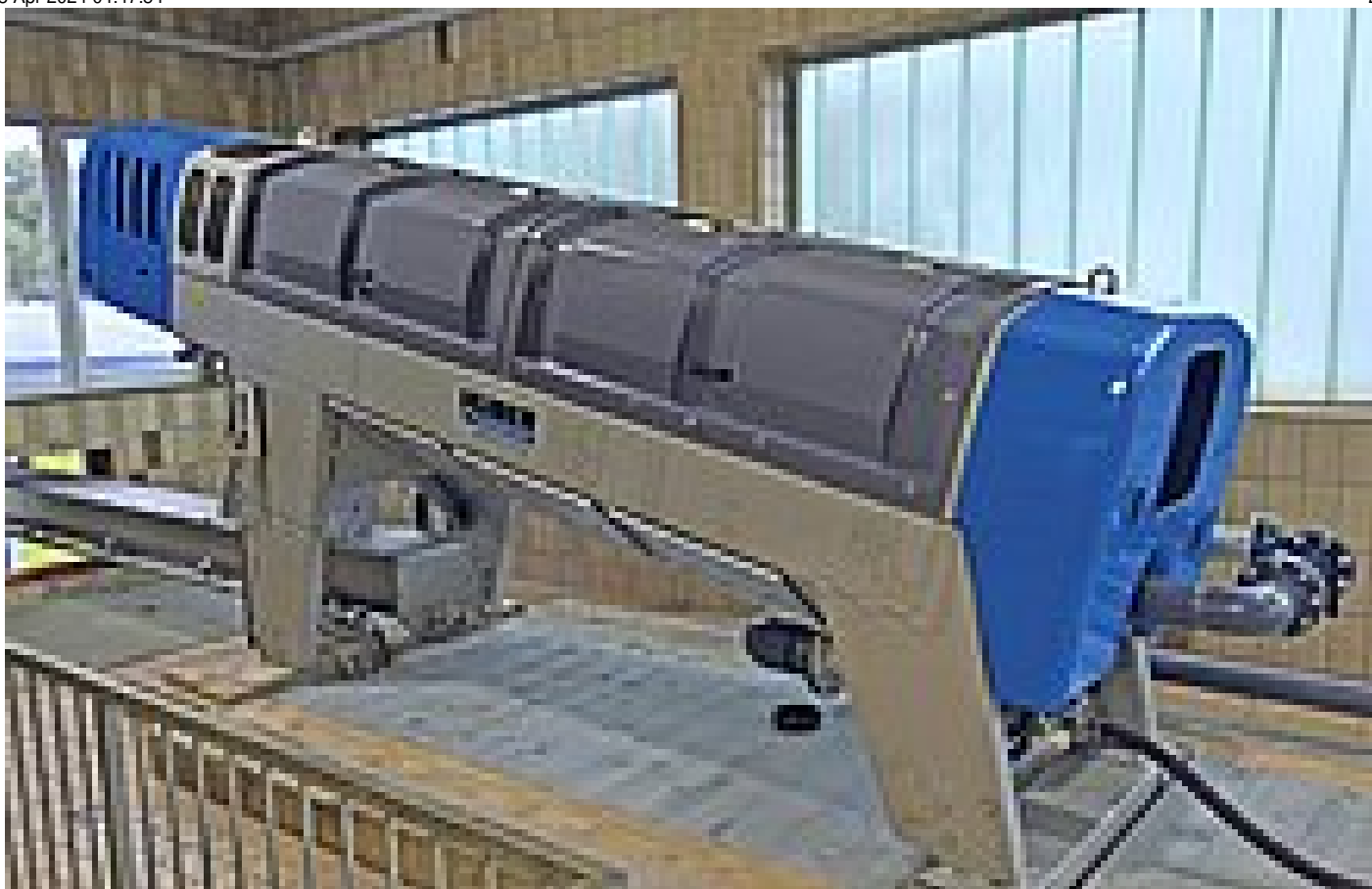
Installazione fissa della pressa a coclea HUBER Q-PRESS® 620.2
