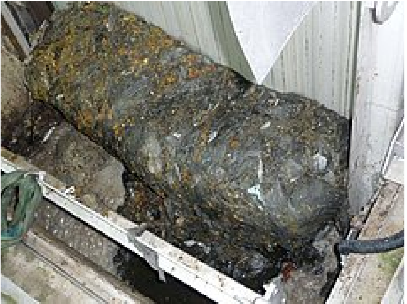
Esempio di massa di grigliato all'inizio del lavaggio - nessun problema per TrashLift
