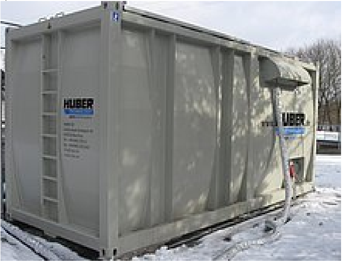
Figura 1: Impianto pilota HUBER per la filtrazione a membrana BioMem® finalizzata alla determinazione dei parametri di progetto (la figura non rappresenta quello del caseificio Milchwerk Jäger)
