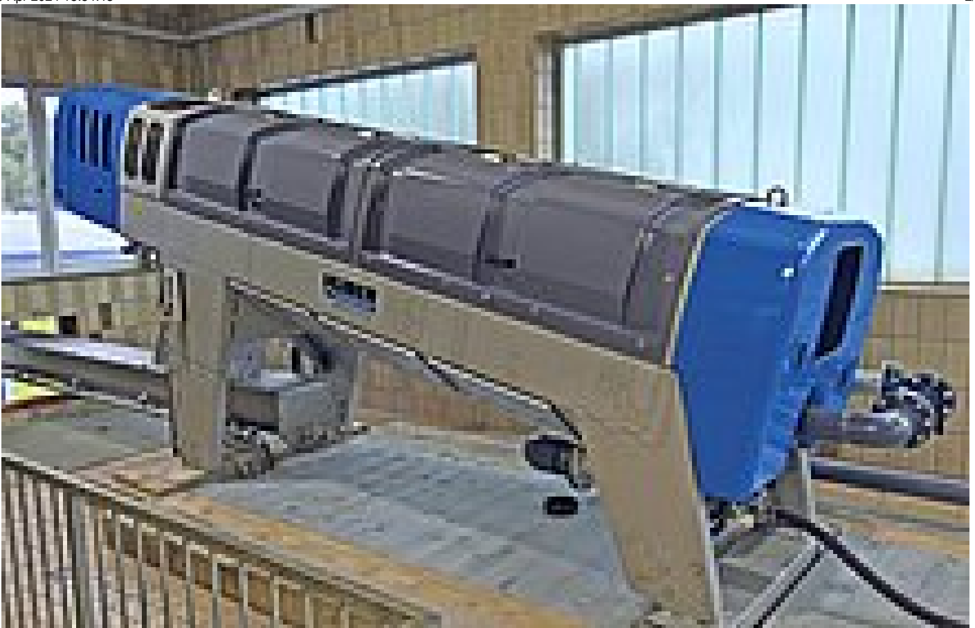
Installation fixe d'une presse à vis sans fin Q-PRESS® 620.2 de HUBER
