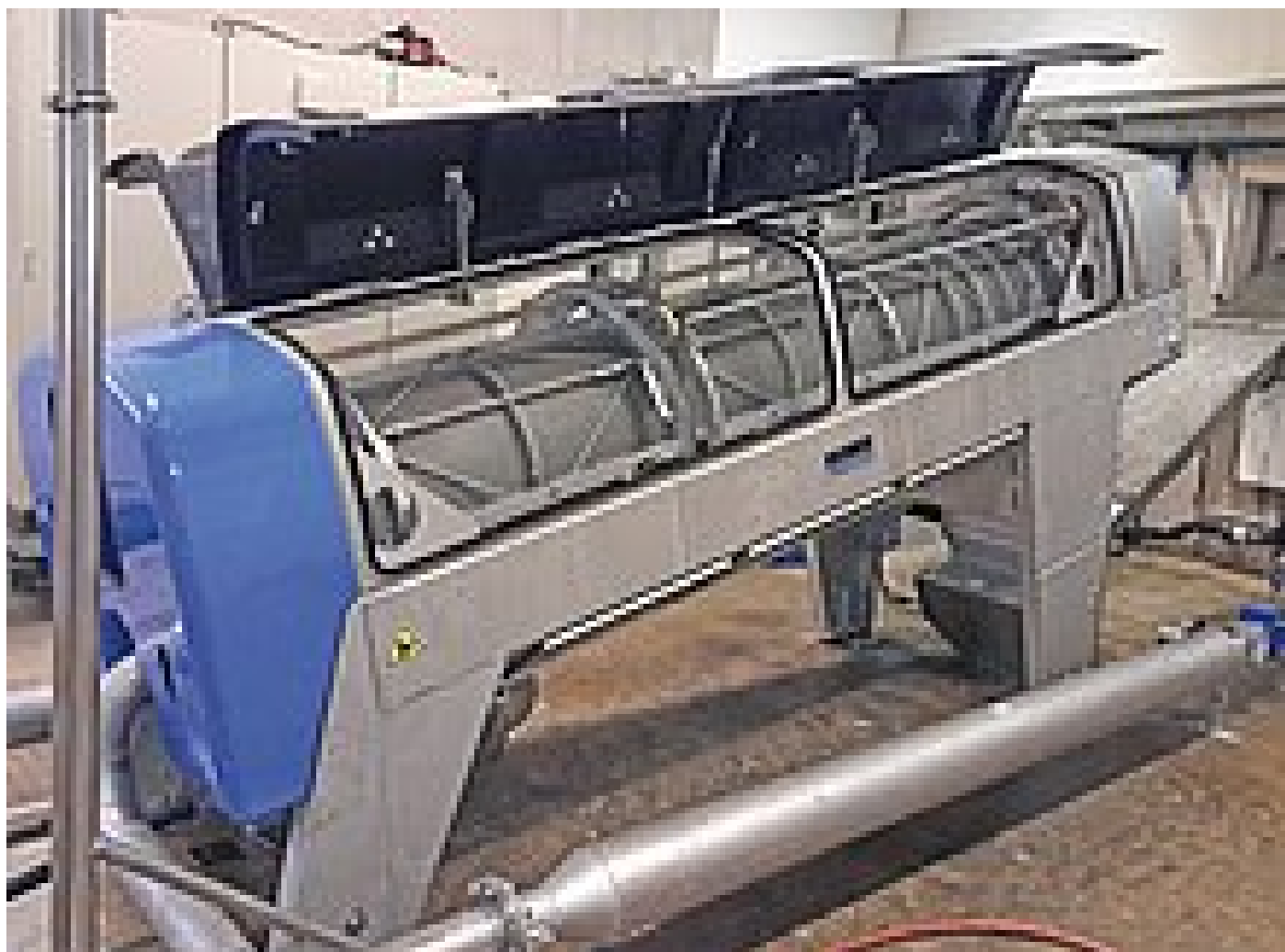
Presse à vis sans fin Q-PRESS® 620.2 de HUBER avec capot ouvert
