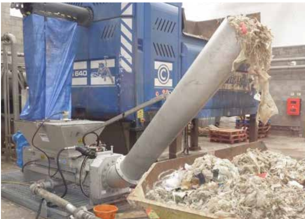
HUBER Waschpresse WAP® bei einer englischen Biomüllaufbereitungsanlage.
