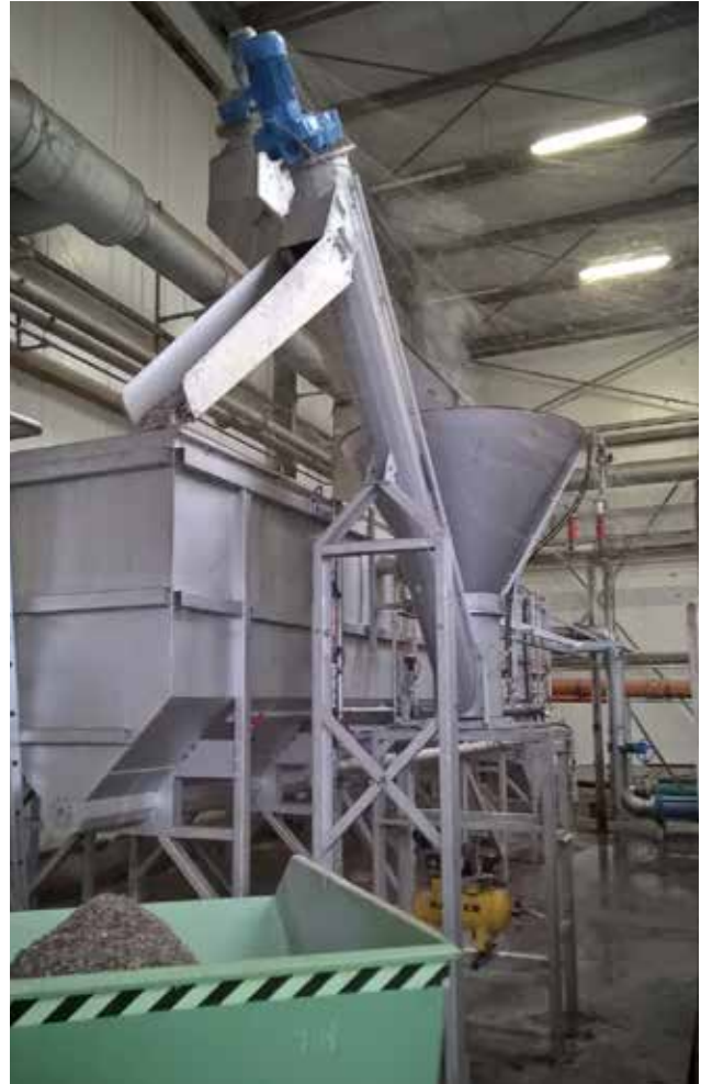
HUBER Sandwaschanlage RoSF G4E Bio bei einer deutschen Biomüllaufbereitungsanlage.
