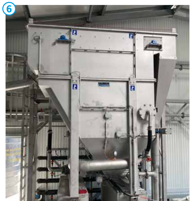
HUBER Druckentspannungsflotation HDF.
