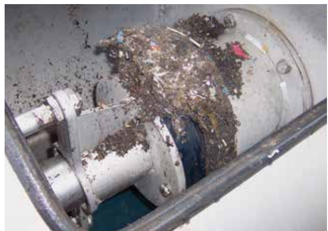
Abgeschiedene und entwässerte Fremdstoffe der HUBER STRAINPRESS® bei einer biologischen Abfallbehandlungsanlage in Deutschland.
