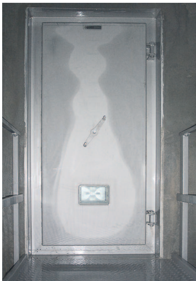
Porte étanche à l'immersion avec verrouillage centralisé et éclairage TT 7.Z (vue intérieure)
