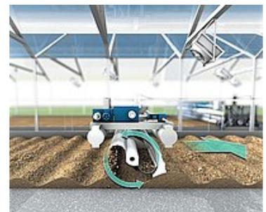
Die Doppelschaufel legt den Schlamm um, während die Maschine durch die Halle fährt
