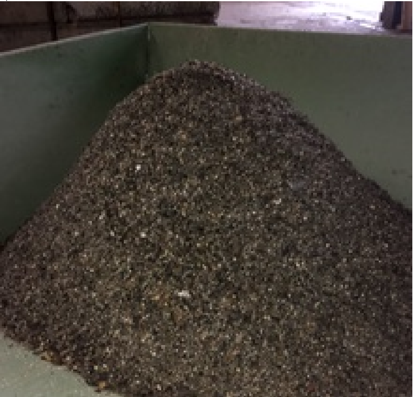
Bild 2: ausgetragener und gewaschener Schwerstoff/Sand
