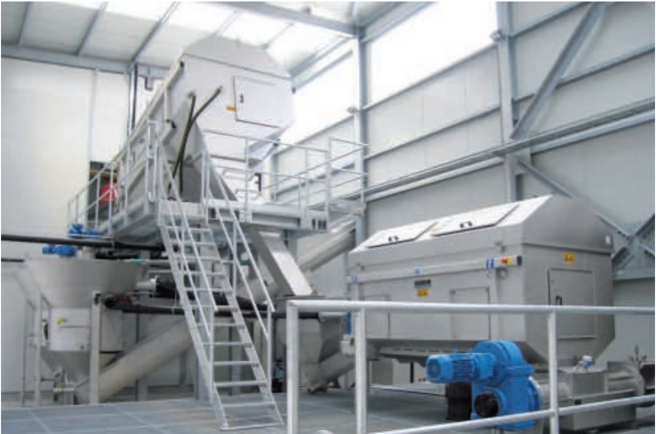
Waschtrommel RoSF 9 mit den zwei nachfolgenden Sandwäschern RoSF 4, Grobstoffwäscher Organiksiebung mit RoMesh® und Organikpresse
