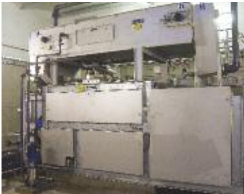
HUBER Nastropressa BS può essere impiegata insieme alla tavola piana Drainbelt, per aumentare l'efficienza
