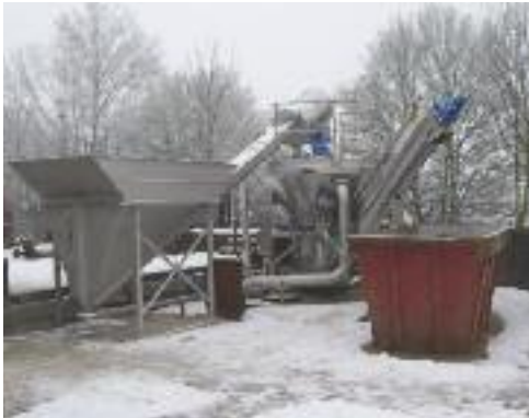
Separatore dei solidi grossolani a tamburo RoSF 8 VT direttamente sopra il lavaggio sabbie RoSF 4
