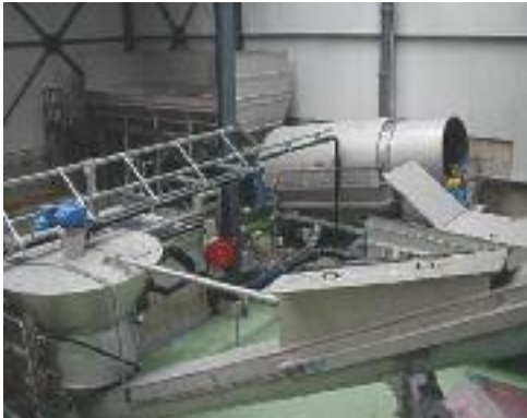
HUBER Impianto Trattamento Sabbie RoSF 5 a Cridec in Svizzera
