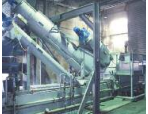
HUBER ROTAMAT® Impianto Compatto Ro5 BIO installato in un impianto di fermentazione di rifiuti organici
