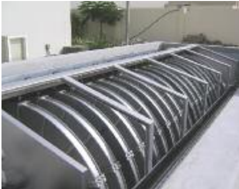
RoDisc® Rotary Mesh Screen fino a 20 dischi in una singola unità
