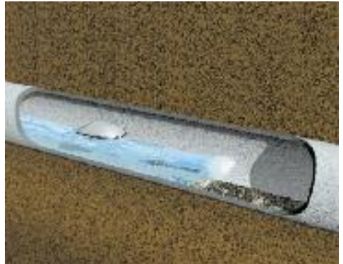
Pulizia di una canalizzazione con un lavaggio a cacciata
