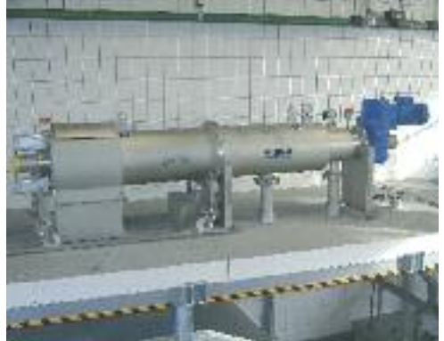
STRAINPRESS® – separazione in continuo di solidi grossolani sotto pressione
