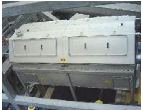
ROTAMAT® Rotary Drum Screen RoMesh® con griglia da 0,2 a 1,0 mm
