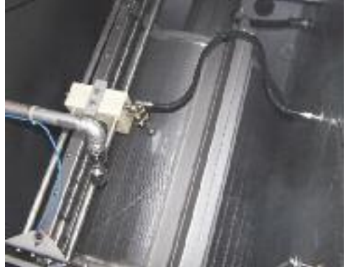
HUBER ROTAMAT® Rotostaccio Ro 2 con spaziatura 1 mm e sistema mobile per la pulizia ad alta pressione
