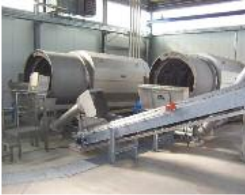
Lavaggio di sabbia contaminata con ROTAMAT® Tamburo Rotante RoSF 9
