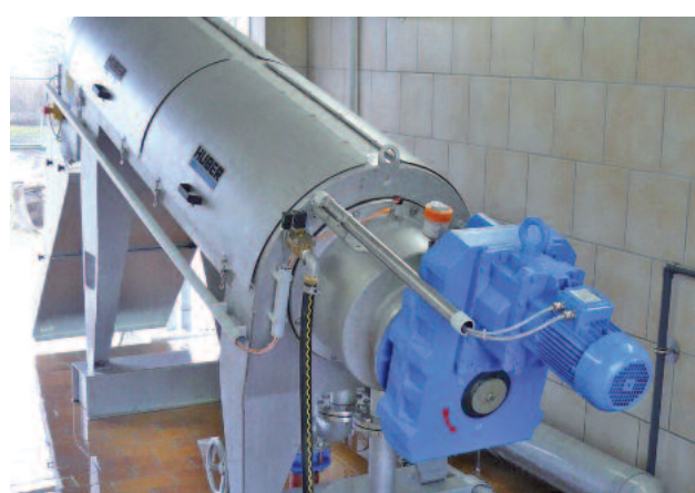
Presse à vis: un fonctionnement continu sans surveillance
