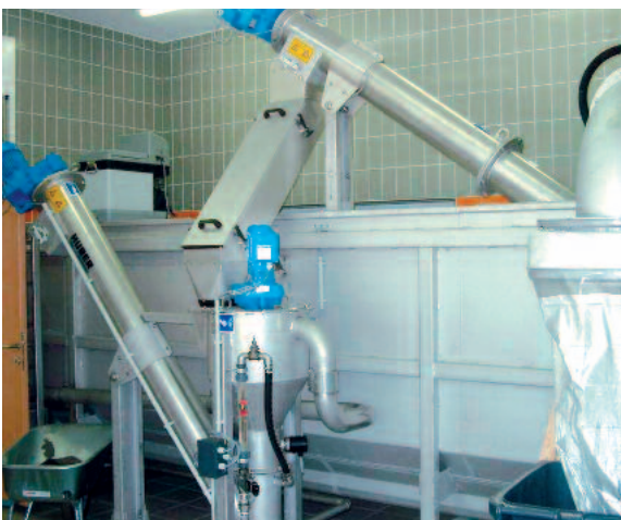
Vis de classification raccordée à un laveur de sable RoSF 4/tC
