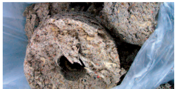
Les refus de grille, lavés et compactés, en font un combustible idéal.
